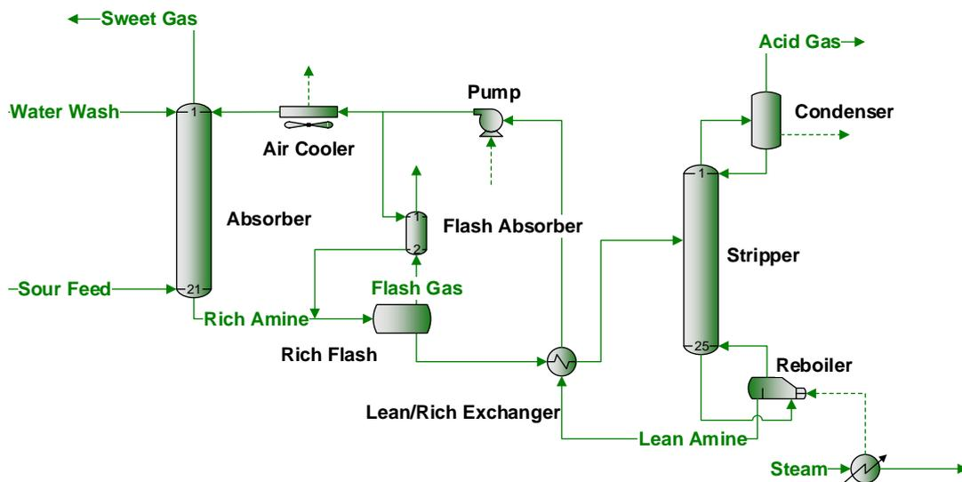
**Figure 1:** Typical GASCO MDEA Sweetening Unit
